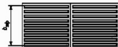
Рисунок А.7 — Форма рифления — прямолинейные поперечные рифы с плоской вершиной (9 шт.), используемые для обустройства полей ожидания и/или получения услуги
