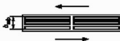
Рисунок А.5 — Форма рифления — прямолинейные параллельные рифы с плоской вершиной (3 шт.), используемые для обустройства направляющего указателя для встречного движения
